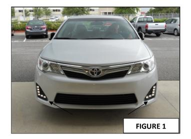
2. LIGHT SHALL BE POSITION IN EXISTING BEZEL LOCATION AS SHOWN IN FIGURE 1.
