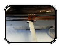
REINSTALL THE LCD PANEL, ROUTING THE INTERFACE CONNECTOR OUT OF THE ASSEMBLY AS SHOWN.
