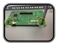
REMOVE TWO T10 TORX FROM THE FACTORY PCB ON THE SIDE WITH THE TOUCH RIBBON CONNECTOR.
