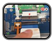
INSERT FACTORY LCD RIBBON AND TOUCH CABLE TO INTRAPHEX CONNECTORS AS SHOWN. BE CAREFUL NOT TO STRESS THE FFC CONNECTORS.
