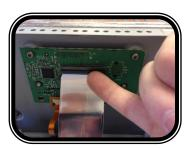
RELEASE THE LOCKING CLIP FROM THE FLAT RIBBON CABLE USING YOUR FINGER NAIL OR A PIC TOOL. DO NOT DAMAGE THE RIBBON CABLE.
