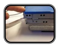
NOW PUT THE TOW SIDES BACK TOGETHER MAKING SURE THAT ALL RIBBON CABLES ARE INSIDE OF CASE AND NOT GETTING PINCHED. THE CABLE EXITING THE CASE SHOULD EXIT ON THE CORNER AS SHOWN.
