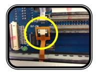
REPLACE THE FACTORY 4 PIN TOUCH RIBBON CABLE TO THE OPEN CONNECTOR ON THE INTRAPHEX PCB. MAKE SURE THE CONTACTS FACE UPWARD. PUSH BLACK LOCKING TABS IN TO SECURE IT.
