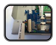
PLUG IN INTERFACE CONNECTOR TO THE PCB.
