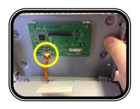
USING FINGERNAIL OR PIC TOOL PULL BACK THE BLACK LOCKING TABS OF THE TOUCH LAYER RIBBON CABLE. REMOVE THE RIBBON CABLE FROM CONNECTOR.
