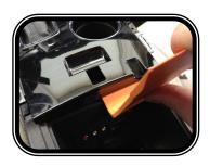
USING PLASTIC PRY TOOL PULL UP FROM THE BACKSIDE TO RELEASE THE CLIPS UNDERNEATH.
