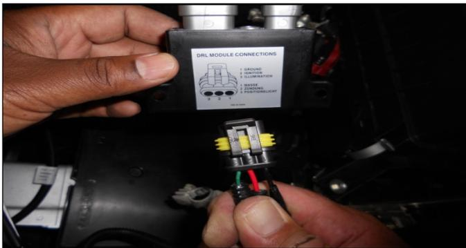
3. CONNECT THE 3-PIN CONNECTOR OF THE POWER HARNESS TO THE CONTROL MODULE.
